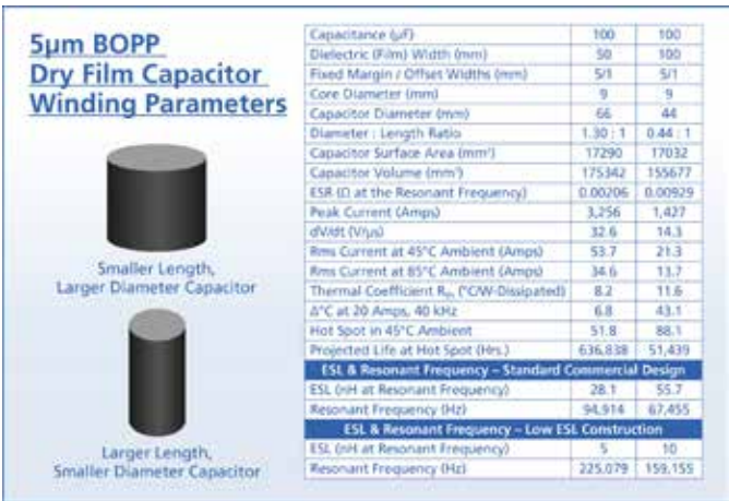
图 5: 5 μm BOPP 干式薄膜电容器的卷绕参数。图片来源: Electronic Concepts
